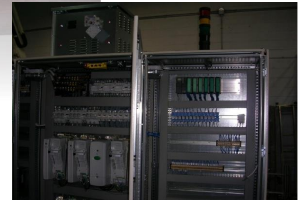
Quadro di comando e gestione per cesoia automatizzata Anno 2014
